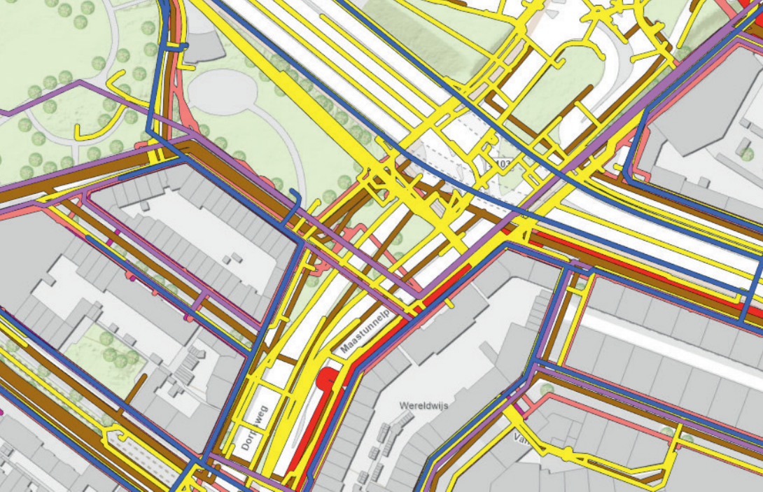
Ondergrondse leidingen in Charlois.
